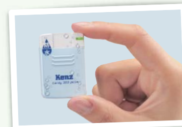
▲SDメモリーカードと同等サイズまで小型軽量化し、防水機能も備えた(株)スズケンの超小型防水ホルター心電計「Cardy303pico+」
